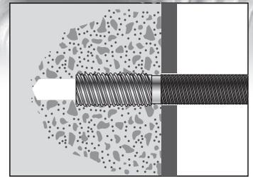
④六角ボルトや全ネジボルト等で取り付け後施工完了
