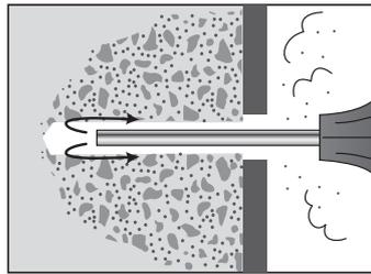
②吸塵材または、ダストポンプで孔内の切粉を除去
